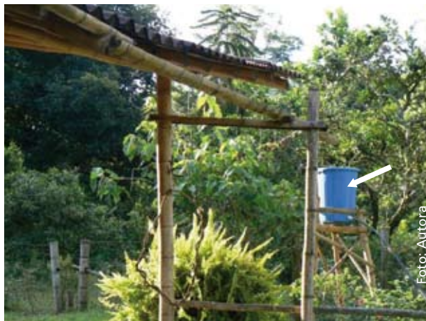
Caneca captadora para la recolección de agua de lluvia
