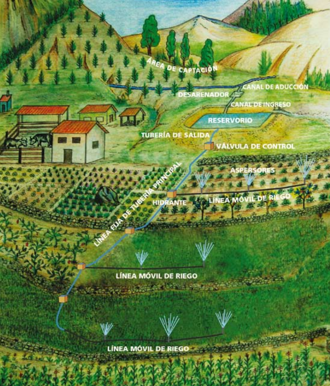
Figura 2. Sistema de riego predial regulado por microrreservorio
