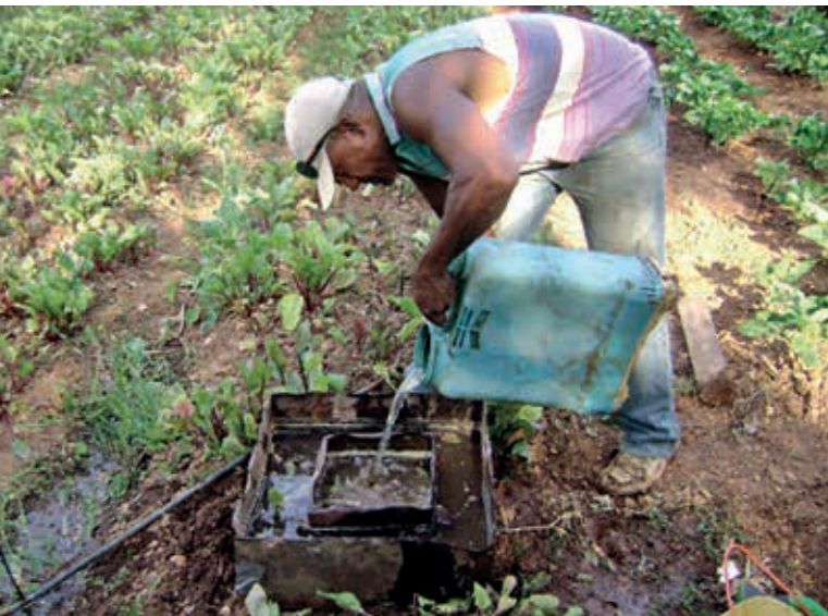
Rolando realizando labor de remoción del suelo y determinando su permeabilidad. 📷 Autores
