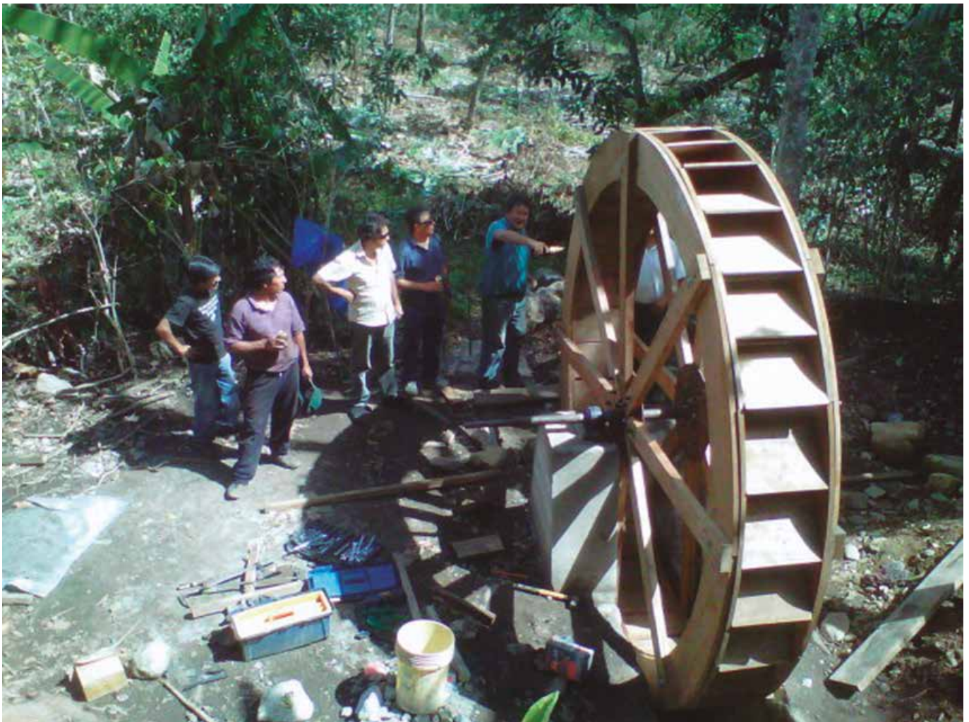
Rueda hidráulica de madera que aprovecha la energía generada por la caída de agua de riachuelos, canales o ríos para energía mecánica.
