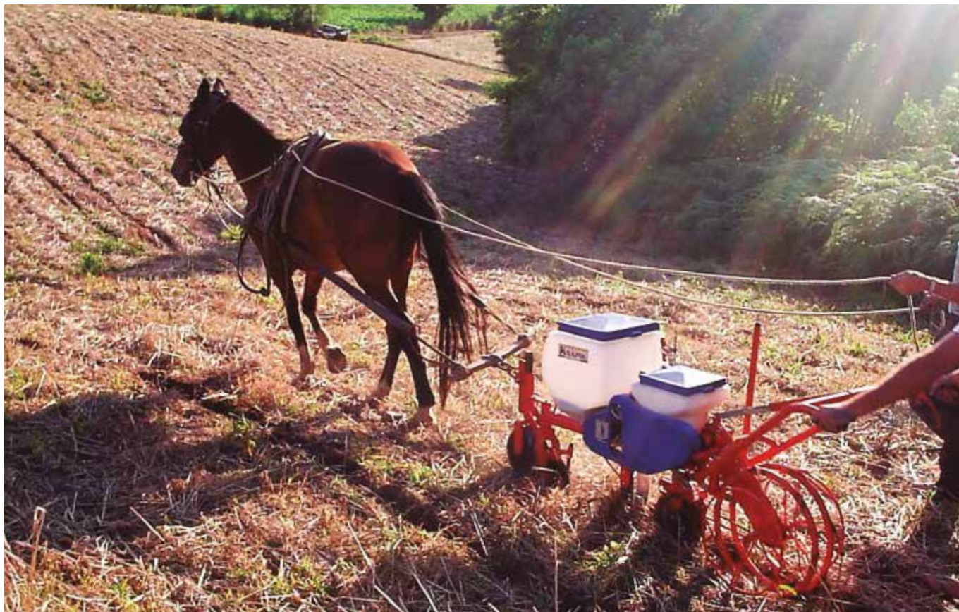
Foto 2. Sembradora directa con tracción animal. 📷 Knapik Ltda, Santa Catarina, Brasil
